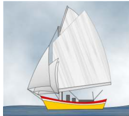
Der Kutter - ein einmastiger Segler mit drei Vorsegeln, einem Topp- und einem Gaffelsegel.
