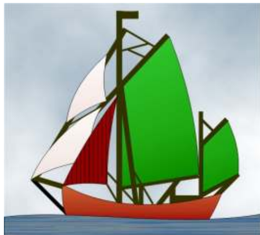
Der Ewer ist ein Segler mit flachem Boden und Seitenschwertern, der häufig an der Nordseeküste zu sehen ist. Oft mit einem Haupt- und einem kleinen Mast wie hier auf der Abbildung zu sehen.
