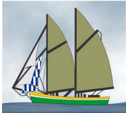
Der Schoner ist daran zu erkennen, dass er mehrere Masten hat, wobei sich der größere hinten befindet. Er hat Gaffelsegel und mehrere Vorsegel.
